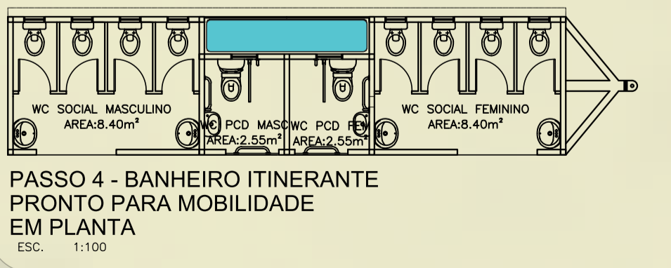
PLANTA DE MOVIMENTO PASSO-A-PASSO - BANHEIRO ITINERANTE PASSO 4 - BANHEIRO ITINERANTE PRONTO PARA MOBILIDADE EM PLANTA ESC 1:100
